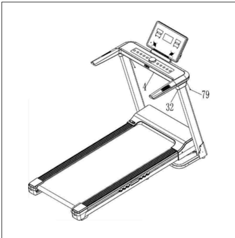
Рисунок 4 — Установка декоративных заглушек под консолью
